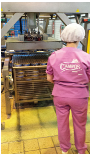
Automatización de paletizado de la línea RO 1000 con la que se evita la continua manipulación de cargas de más de 1 kg a diferentes alturas.
