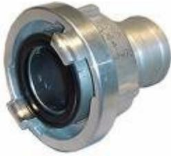
La boca que se muestra en la imagen es la boca que instalamos en el silo, ya sea este metálico, de obra o de rafia. Se han de instalar dos, ya que por una se impulsa el hueso y por otra aspiramos el polvo que se puede generar en la descarga. Es necesario que los silos sean estancos para evitar pérdidas de polvo en la impulsión en la habitación donde estén ubicados.
