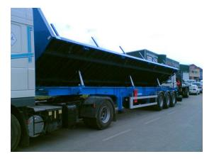
CARROZADOS PARA EL TRANSPORTES DE RECICLADOS: Especializados tambien en la fabricación y carrozado de bañeras para chatarra, fabricadas en acero especial antidesgaste. Contamos en nuestras instalaciones con el equipo de profesionales y la experiencia que permite abordar esta especialidad en los plazos acordados con el cliente, manteniendo nuestro compromiso de trabajo y servcio de calidad, para satisfacer las necesidades de nuestros clientes.
