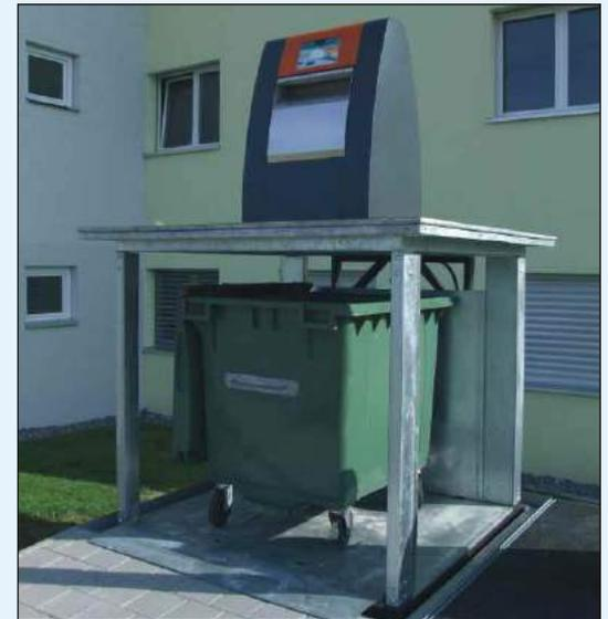
Elevación de la plataforma para extraer el contenedor
