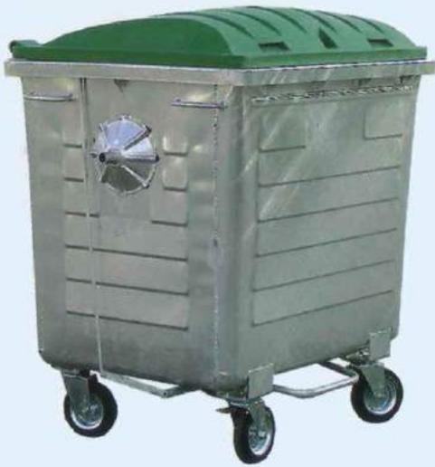
Contenedor metálico para la recogida lateral y trasera. Cuerpo de acero con los cantos redondeados. Dispone de 4 ruedas giratorias Ø 20 cm. Tapa de polietileno con diferentes bocas disponible en los colores de recogida selectiva. Opcional: Freno centralizado para ruedas delanteras. Pedal de apertura de tapa fabricado en acero. Tapas para recogida selectiva.
