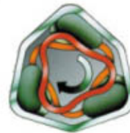
Detalle amortiguación por barras de caucho
