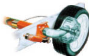
Detalle amortiguación por amortiguadores
