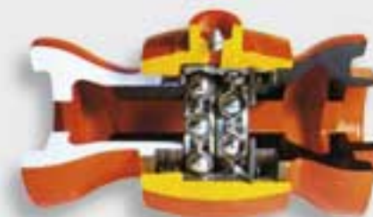
Sección del conjunto de rodadura SR-25-T
