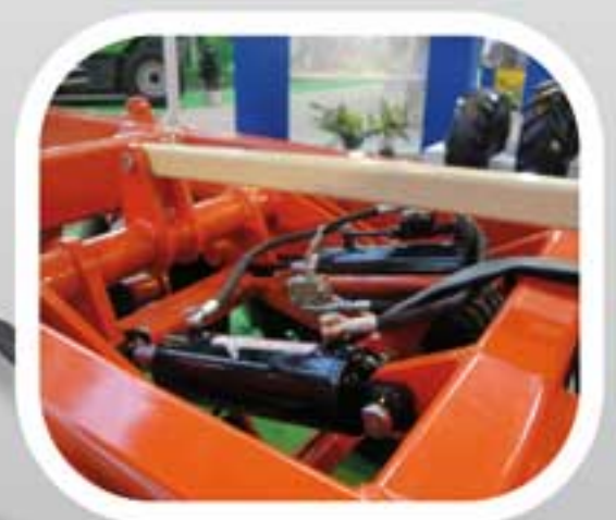
Detalle del equipo de transporte, con dos cilindros hidráulicos, y un final de carrera, para controlar la profundidad de clavado.
