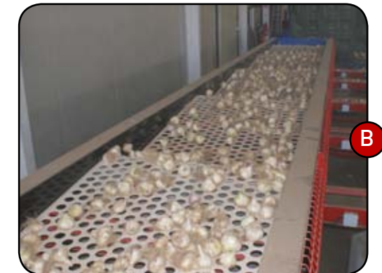
B. Calibrado preciso. La larga superficie de cada módulo y la regulación de la velocidad de cinta da el tiempo necesario para la exacta selección de cada bulbo en su calibre.
