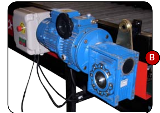
B. Los rodillos son accionados por un motor eléctrico de 1 CV con velocidad regulable dependiendo del estado en que llegan los bulbos del campo.
