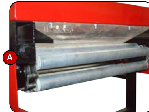
A. La lámina flexible de polietileno facilita la caída de los bulbos evitando golpes y daños.
