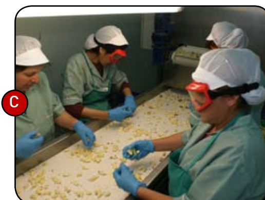
C. Cinta de control. La cinta posterior a la cámara de aire a presión permite eliminar los dientes dañados o de calidad inferior.
