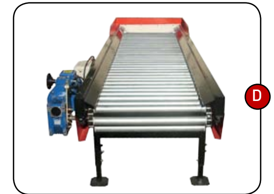
D. La longitud de la mesa y los 33 rodillos de trabajo aseguran una perfecta limpieza y permite el trabajo de hasta 5 personas de inspección del producto.
