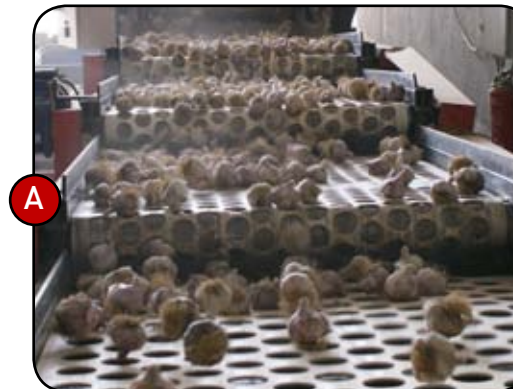
A. Módulos en cascada. El diseño modular de las unidades de clasificación permiten combinar tantas secciones como se quiera para un mayor rango de calidades.
