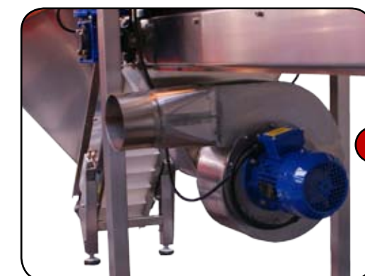
B. Extracción de residuos. Las hojas y pieles son eliminadas por ventiladores.
