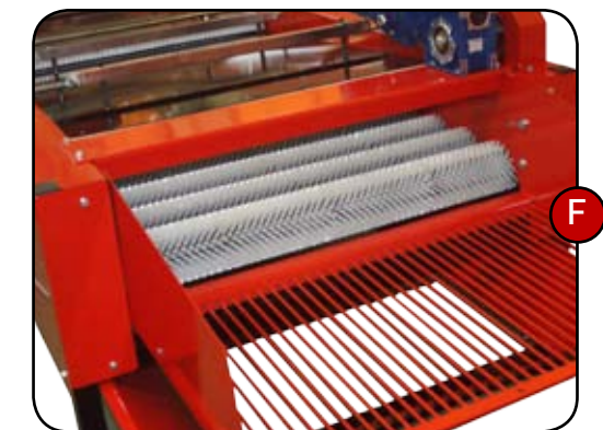
F. La parrilla final separa los últimos restos de tierra de los bulbos evitando la entrada en el bin de almacenamiento.
