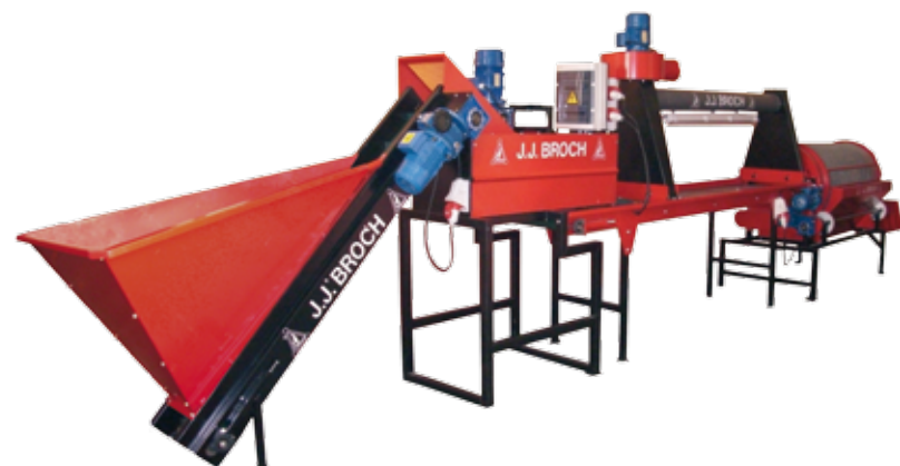
Desgranadora de cabezas de ajo La separación y clasificación de los dientes es el primer paso para una plantación homogénea y regular. El alto rendimiento de trabajo permite adecuar la cantidad desgranada al ritmo de plantación.
