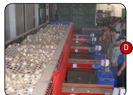
D. Óptimas condiciones de organización. Cada módulo tiene una salida independiente con espacio suficiente para el trabajador de inspección, control y apilado.
