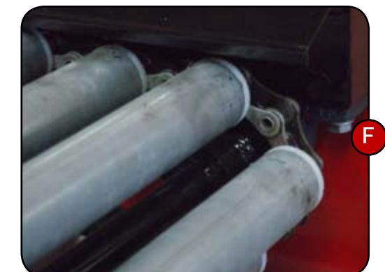
F. El diámetro de los rodillos facilita la rotación continua de las cabezas de ajo mejorando la limpieza y su control. El espacio entre rodillos se puede reducir con la instalación de varillas.
