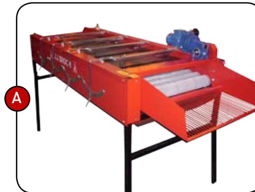
A. 3 metros de cepillado inferior y superior. Elimina de forma eficiente la tierra y las hojas externas coloreadas.
