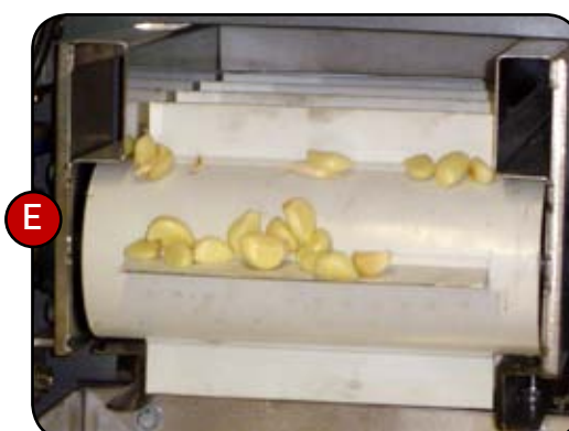
E. Eficacia del 98%. El calentamiento previo antes del desgrane y en la cinta de alimentación consiguen una alta eficiencia en el pelado.
