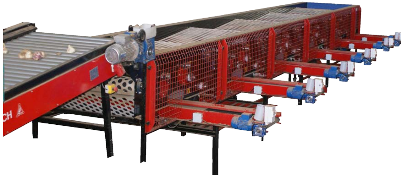
C. Cuidadosa manipulación del bulbo. Las cintas de descarga se sitúan a una altura mínima para evitar daños. Pueden descargar tanto en Bins como en cajas pequeñas de manejo manual.
