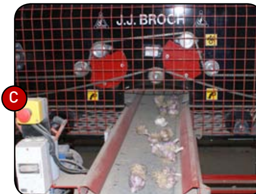
C. Cuidadosa manipulación del bulbo. Las cintas de descarga se sitúan a una altura mínima para evitar daños. Pueden descargar tanto en Bins como en cajas pequeñas de manejo manual.
