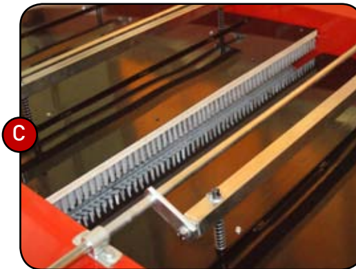
C. Dos placas de cepillado superior con doble regulacion permiten ajustar la intensidad del cepillado.
