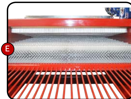
E. Los filamentos sintéticos especiales para ajo facilitan una excelente rotación de los bulbos y aseguran una cuidadosa limpieza sin daños.
