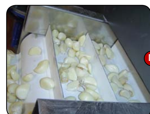
D. Construcción para uso alimentario. Construida en acero inoxidable y PVC de uso alimentario según las normas CE de máquinas para manipulación de alimentos.
