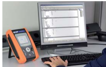
Transferencia de datos a PC a través de conexión óptica/USB u óptico/Wifi
