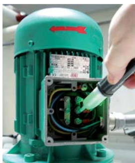
Reconocimiento fase L2 e indicación del correcto sentido cíclico de las fases
