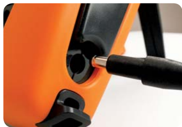
Alimentación y cargador de las baterías en el propio equipo
