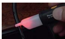
Encendido LED rojo con tensión detectada
