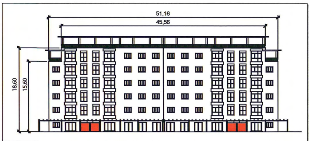
Figura 10) Croquis del edificio (Fachadas Noreste y Suroeste) - Madrid
