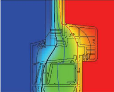
El coeficiente  $U_{wv}$  de la ventana depende del acristalamiento empleado y el valor  $U_f$  de los perfiles. El valor  $U_f$  del sistema de hoja oculta GlassWin dependiendo de la combinación de hoja y marco empleada es de **1,3 W/m²K**.
