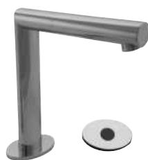
Caño alto con sensor remoto. Conexiones de 3/8", sin vaciador y aireador "plus". Incluye sensor remoto independiente. El caudal a 3 bares (con agua mezclada) es de 10,5 l/min.
