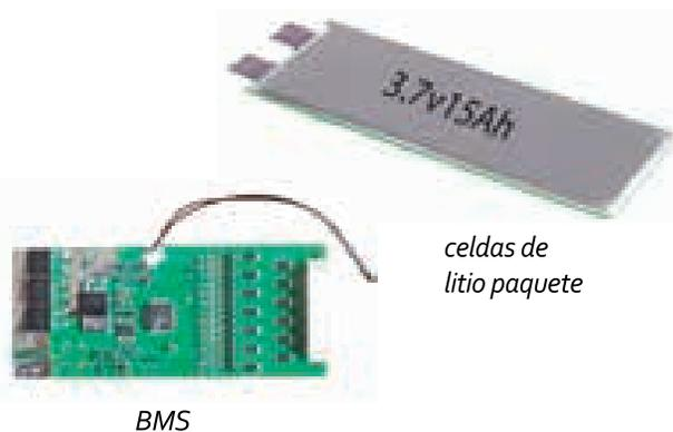
La **capacidad eléctrica** de una batería se mide en amperios hora (Ah), que está muy relacionada con la energía que es capaz de guardar (Wh, vatios hora) y su voltaje (V, voltios), relacionándose del siguiente modo:  $Ah = Wh / V$
