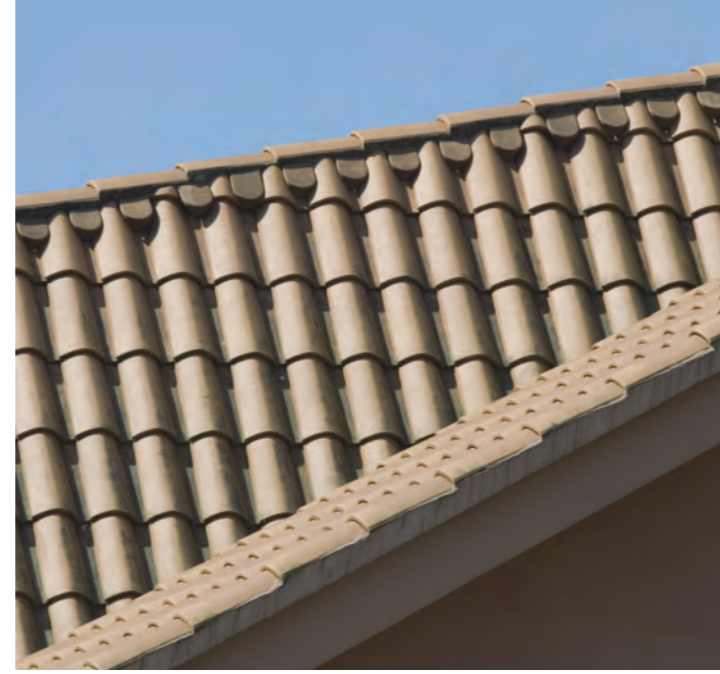
marrón teja cerámica mixta de: 466 x 275 mm. / coloración en masa: marrón / peso: 3800 gr. / 11,3 piezas por m 2
