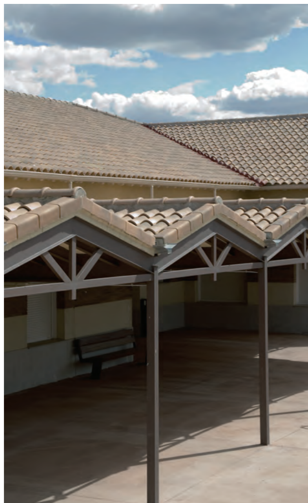
duna flameada teja cerámica mixta de: 472 x 282 mm. / coloración en masa: salmón / peso: 3625 gr. / 1,3 piezas por m 2
