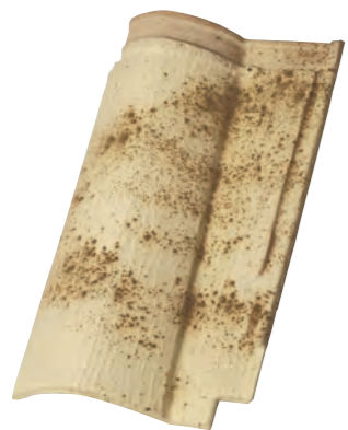
ruidera teja cerámica mixta de: 466 x 275 mm. / coloración en masa: roja / peso: 3800 gr. / 11,3 piezas por m 2
