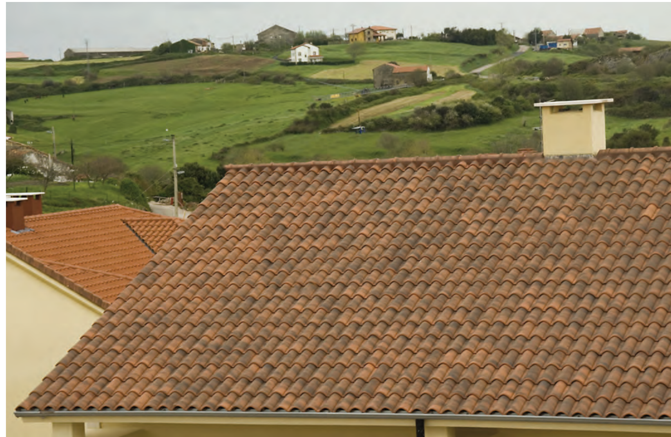
roja envejecida teja cerámica mixta de: 466 x 275 mm. / coloración en masa: rojo / peso: 3800 gr. / 11,3 piezas por m 2
