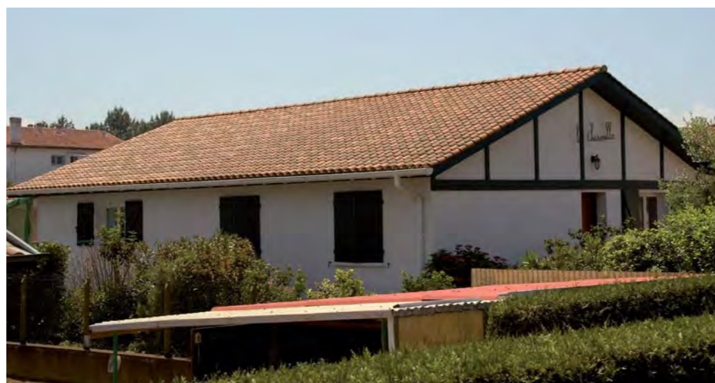
roja envejecida teja cerámica occitania de: 466 x 273 mm. / coloración en masa: rojo / peso: 3840 gr. / 12,2 piezas por m 2
