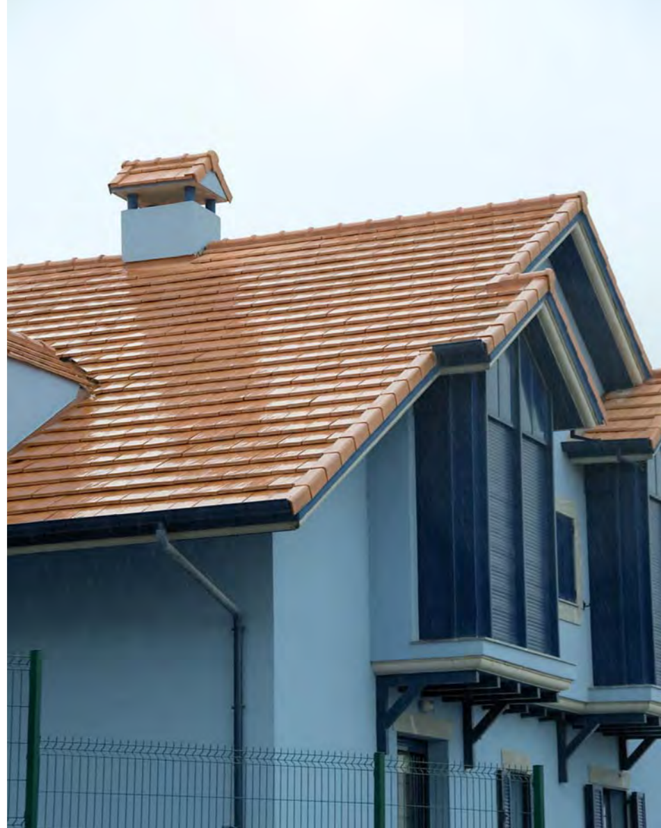
moneo roja teja cerámica plana moneo de: 465 x 276 mm, / coloración en masa: rojo / peso: 3950 gr. / 11,4 piezas por m 2 inclinación mínima recomendada 45°
