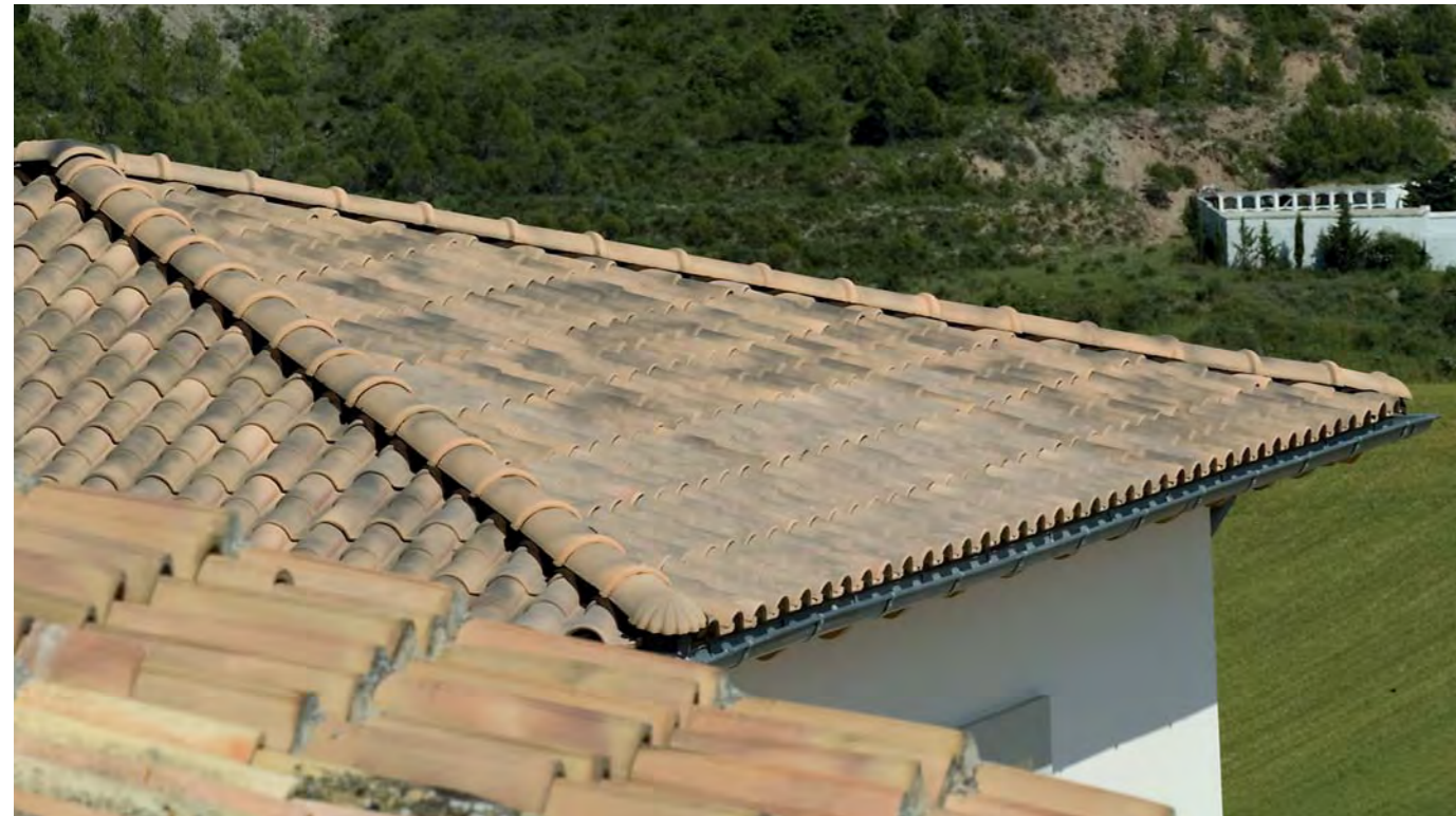
crema flameada teja cerámica occitania de: 466 x 273 mm. / coloración en masa: rojo / peso: 3840 gr. / 12,2 piezas por m 2
