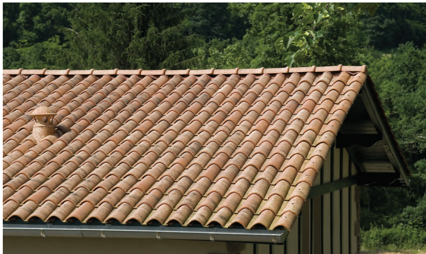
rioja teja cerámica mixta de: 466 x 275 mm. / coloración en masa: rojo / peso: 3800 gr. / 11,3 piezas por m 2
