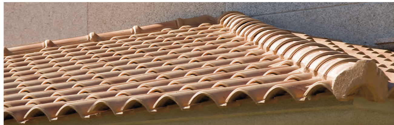
duna fogueada teja cerámica mixta de: 472 x 282 mm. / coloración en masa: salmón / peso: 3625 gr. / 11,3 piezas por m 2
