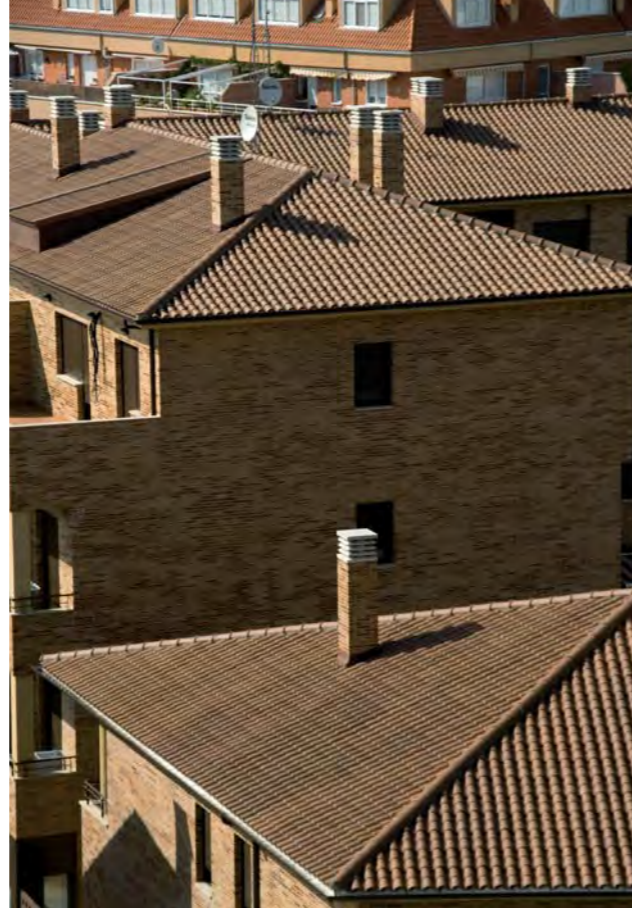
marrón teja cerámica occitania de: 466 x 273 mm. / coloración en masa: marrón / peso: 3840 gr. / 12,2 piezas por m 2
